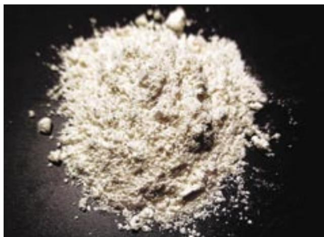
Fig. 19 - Polvere di huntite preparata per l'esame diffrattometrico.
