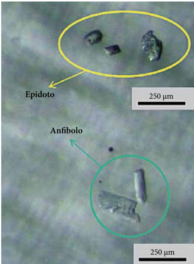
Fig. 11 - Immagine al microscopio stereoscopico di alcuni minerali pesanti individuati nel campione PR1A. - Microscope photo of some heavy minerals identified in the PR1A sample.
