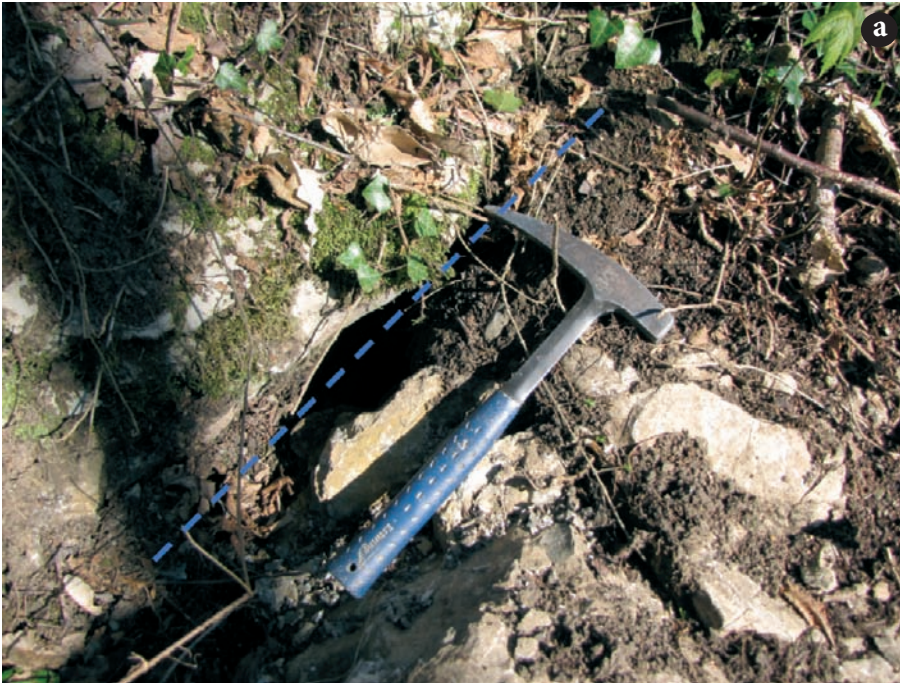
Fig. 12 - Famiglia di fratture n. 3: foro di dissoluzione impostato lungo una frattura 124/65 (a) e gradino morfologico impostato lungo una frattura 290/vert (b).
