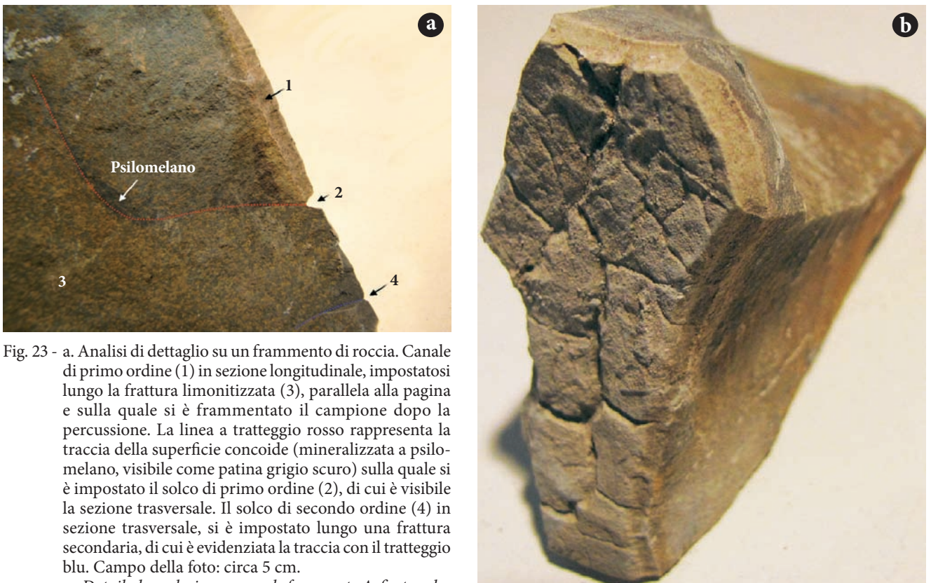
Fig. 23 - b. Frammento in cui è particolarmente evidente il carattere concoide delle fratture limonitizzate (tipico delle rocce marnose) su cui si sono impostati i solchi principali. Sulla superficie carsificata è inoltre evidente il reticolo di solchi di secondo ordine dovuto alla microfratturazione.
