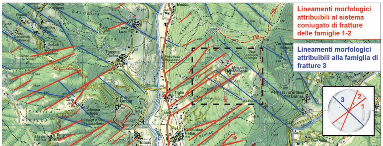
Fig. 7 - Influenza dei sistemi di fratture sulla geomorfologia e idrografia superficiale. Riquadro a tratteggio nero: l'area di studio. Cartografia di base: Carta Topografica per Escursionisti (Ed. Tabacco), Foglio 041. - Fracture patterns have a profound influence on geomorphology and superficial hydrography. Dashed square: the investigated area. Base map: Carta Topografica per Escursionisti (Ed. Tabacco), Sheet 041.
