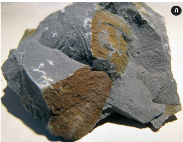
Fig. 19- Frammenti di roccia freschi (circa 10 cm) che mostrano diversi tipi di fratture (a, b). Quelle principali color ocra (limonite) danno origine ai solchi di primo ordine, quelle secondarie (grigie) alle scannellature di secondo ordine. Le fratture sono concoidi (carattere particolarmente evidente in b) e presenti in tutta la massa, indice questo di stress meccanico diffuso. L'apertura è praticamente nulla e l'orientazione è casuale.
