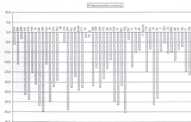
Fig. 8 - Abbassamento medio annuo (o innalzamento in due casi) della falda misurato nei 52 pozzi analizzati nel periodo 1967-1998 (in cm).
