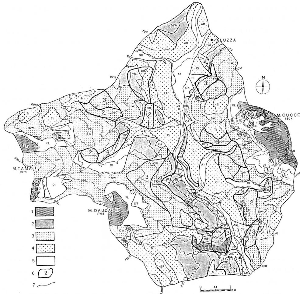
Fig. 5 - Carta litotecnica. 1=litologie a comportamento geomeccanico ottimo; 2=litologie a c.g. buono; 3=litologie a c.g. medio; 4=litologie a c.g. scarso; 5=litologie a c.g. pessimo; 6=geometrie di separazione della massa rocciosa (1=4-5 serie; 2=5-6 serie; 3=6-7 serie; 4=8-9 serie di discontinuità); 7=confine litologico.
